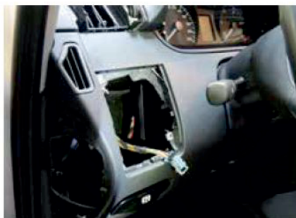
Lokátor se dlouhodobě ukrývá třeba pod palubní desku, kde je připojen na elektrické rozvody vozu.
