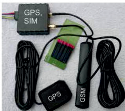
GPS lokátor s externími anténami určený k trvalému monitorování vozidla. Zabudování trvá přibližně 60 minut. Přesnost +/- 5 metrů.
